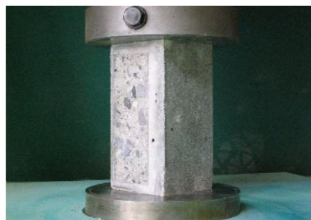
圧縮強度試験
