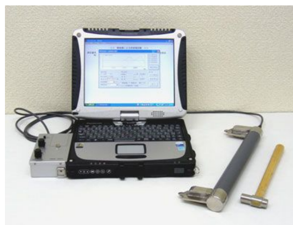
衝撃弾性波試験（表面2点法）
